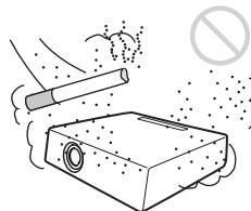
N'installez pas le projecteur dans un environnement très poussiéreux ou enfumé. Le filtre à air pourrait se colmater avec, pour résultat, un dysfonctionnement ou des dommages du projecteur. La poussière colmatée ferait obstacle au passage de l'air à travers le filtre et il en résulterait une surchauffe interne du projecteur. Nettoyez périodiquement le filtre.
